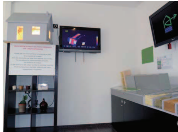
Grâce à une caméra thermique, les visiteurs visualisent les déperditions de chaleurs liées aux ponts thermiques.
